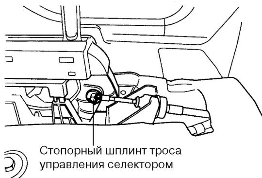
4. Отсоединить трос управления селектором, отжав его отверткой.
