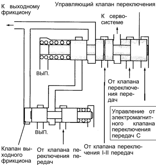
**Управляющий клапан переключения и клапан выходного фрикциона**
