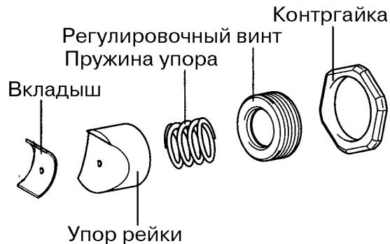
13. При среднем положении рейки завернуть регулировочный винт упора рейки в картер рулевого механизма и торцовым ключом на 14 мм затянуть его моментом 12 Н.м, затем отвернуть винт на угол 30-60° и затянуть контргайку винта указанным моментом.
