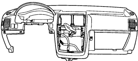
7. Разъединить разъем датчика температуры (термистора) испарителя.
