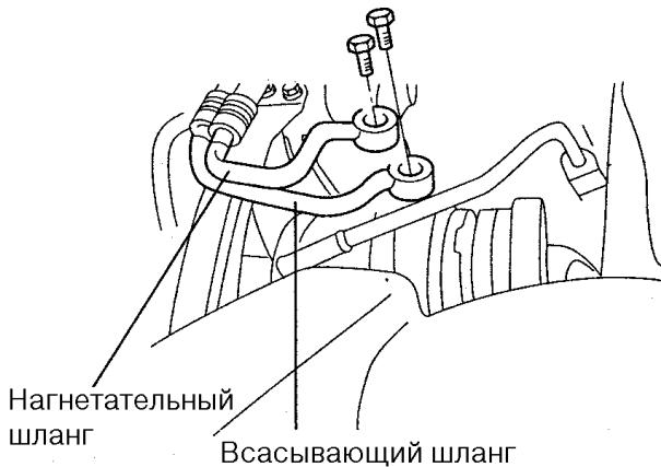
4. Отвернуть 4 болта крепления компрессора,
