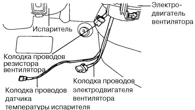
9. Снять испаритель в сборе.
