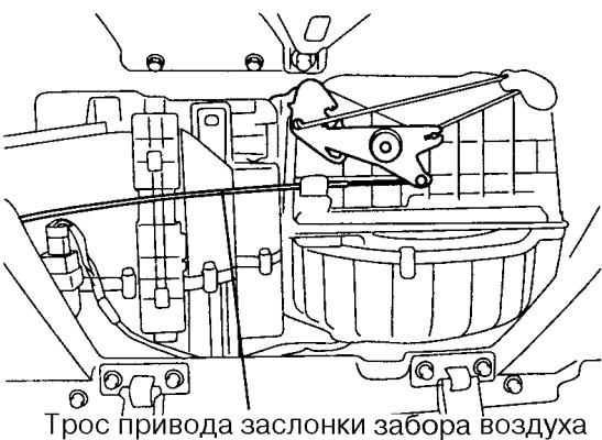
3. Снять крышку воздушного фильтра, нажав на фиксатор со стороны кондиционера.
