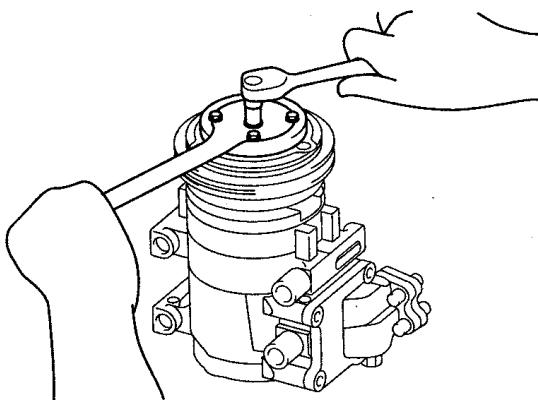
6. Проверить щупом зазор между ступицей муфты и поверхностью шкива.
