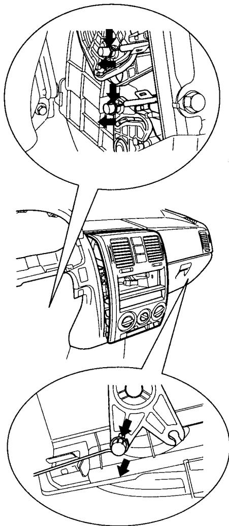
5. Отсоединить центральную панель приборной панели за ее нижнюю часть.
