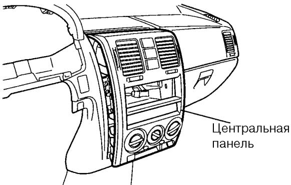
3. Разъединить разъемы выключателей и снять центральную панель.
