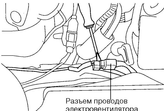
5. Снять электровентилятор (конденсор).
