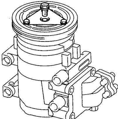
5. Завернуть новый болт крепления ступицы в торец вала компрессора и затянуть его требуемым моментом
