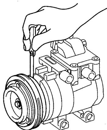
7. Если установочный зазор ступицы не укладывается в указанные пределы, отрегулировать его, поставив регулировочную прокладку соответствующей толщины.
