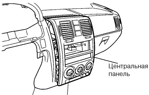
6. Разъединить разъемы выключателей и снять центральную панель.
