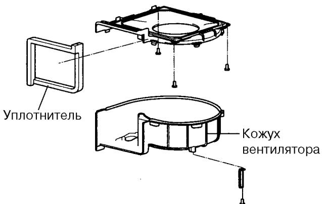
3. Снять кожух забора воздуха, отсоединить рычаг и поводок привода заслонки.
