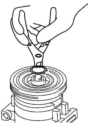
4. Установить регулировочную прокладку требуемой толщины шлицевыми пазами внутрь, установить ступицу на конец вала компрессора.
