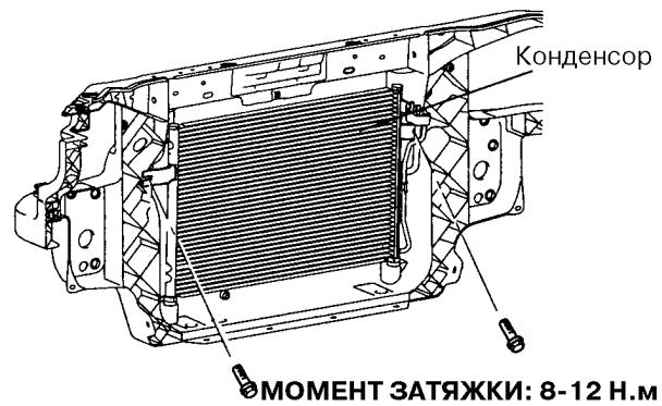
8. Снять конденсор движением вверх, отжав радиатор в направлении к задней части автомобиля.
