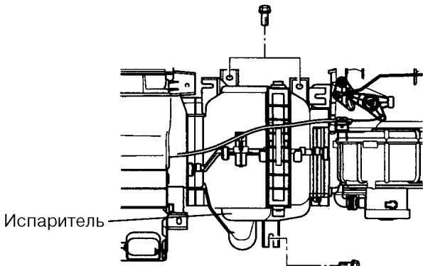
7. Снять вентилятор.
