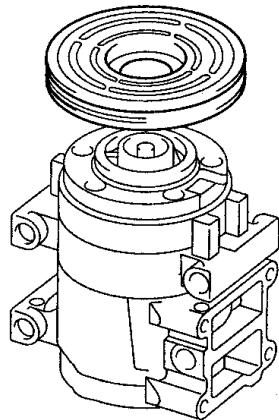
2. Снять ступицу и регулировочную прокладку с вала компрессора. При затрудненном снятии завернуть болт 8 мм в отверстие торца вала и снять ступицу с вала.
