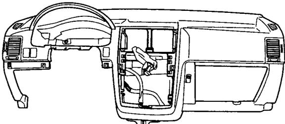
8. Разъединить разъем датчика температуры испарителя (термистора), разъем резистора вентилятора и разъем электродвигателя вентилятора.
