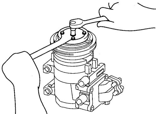
4. Снять с компрессора шкив в сборе с подшипником.
