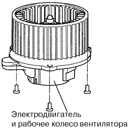
2. Отвернуть винты крепления кожуха забора воздуха и кожуха вентилятора.
