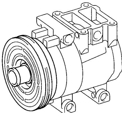
6. Снять с компрессора оправку для запрессовки сальника и защитное кольцо.
