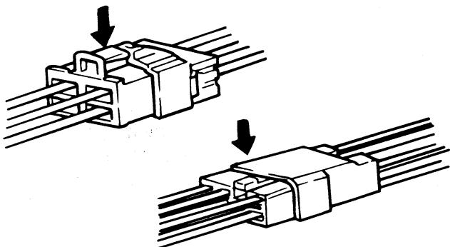
10. Разъемы с фиксатором соединять до защелкивания фиксатора.
