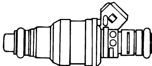
3. Установить форсунку в топливную рампу, поворачивая форсунку влево-вправо.
