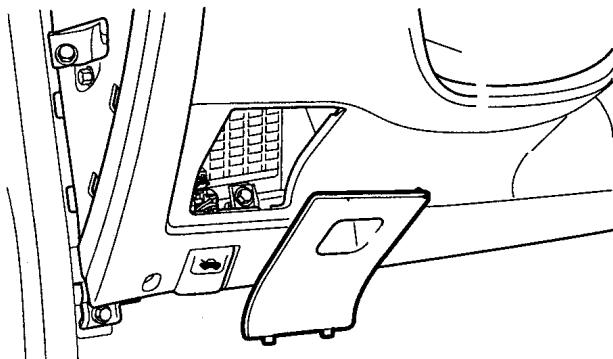
4. Отвернуть два болта и два винта крепления ЭБУ.
