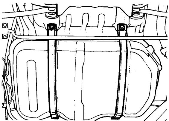
2. Присоединить переливной шланг к баку и наливной горловине, вставив его на глубину около 40 мм.
