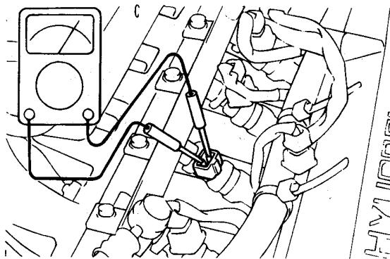
1. Разъединить разъем форсунки и проверить сопротивление на ее выводах.
