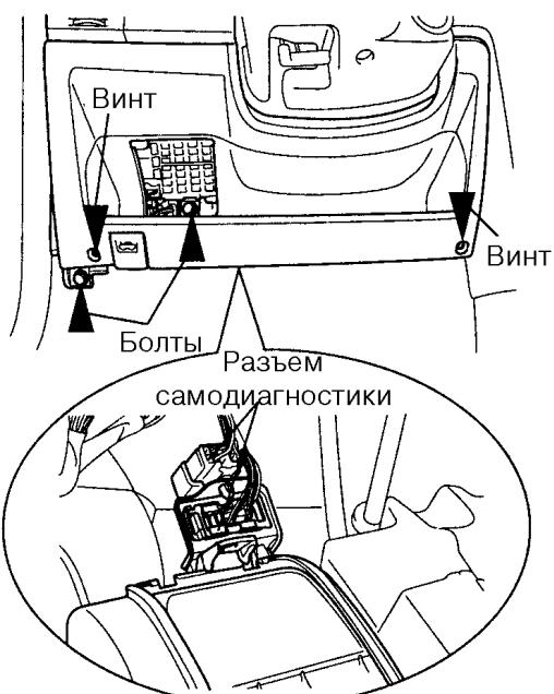
5. Разъединить разъем линии передачи данных (DLC), отсоединить трос привода замка капота и снять нижнюю облицовку панели приборов.
