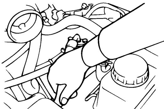
2. Для сброса давления в топливных трубопроводах и шлангах запустить двигатель при отключенном топливном насосе и подождать, пока двигатель остановится.
