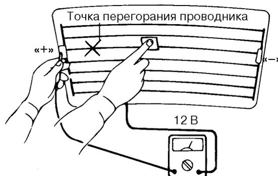
3. Если имеется перегорание проводника посередине между центральной точкой и выводом («-»), вольтметр покажет напряжение 0 В.
