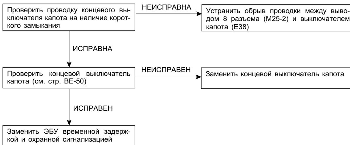
3. При проверке сигнализации путем открывания двери изнутри салона сирена не включается (при открывании двери задка и капота сирена работает).
