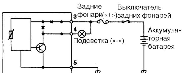
3. Проверить изменение яркости подсветки приборов. Если яркость подсветки при вращении рукоятки регулятора меняется плавно и без мигания, регулятор исправен.
