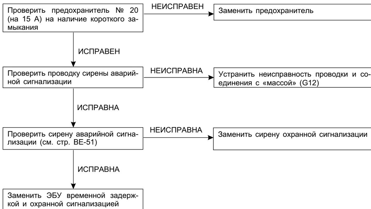
2. При проверке сигнализации путем открывания капота из салона сигнализация не включается.
