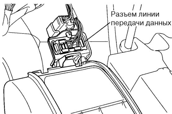
4. Снять ЭБУ ВЗ/ОС с кронштейна, отвернув гайки крепления.
