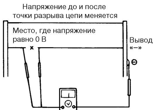
5. проверить омметром сопротивление каждого проводника элемента обогрева между одним из выводов и средней точкой проводника и между этим же выводом и средней точкой соседнего проводника. Сопротивление секции, в который имеется разрыв, будет в два раза больше сопротивления другой секции. Перемещать щуп тестера по секции с разрывом до точки, где величина сопротивления резко меняется.
