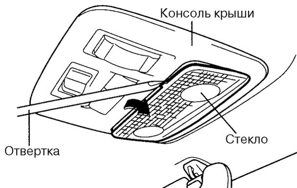
2. Снять консоль крыши, отвернув 2 винта крепления и разъединив разъем крыши.
