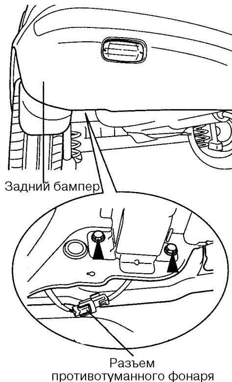
4. Разъединить облицовку и балку бампера, отвернув винты крепления облицовки к балке.
