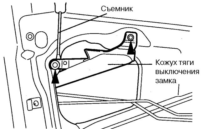
4. Отвернуть винты крепления замка (3EA),
